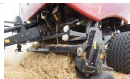
Az 5-tengelyes rendfelszedő az összes rövid szárat is megbízhatóan szedi fel, nagy sebességnél is.
